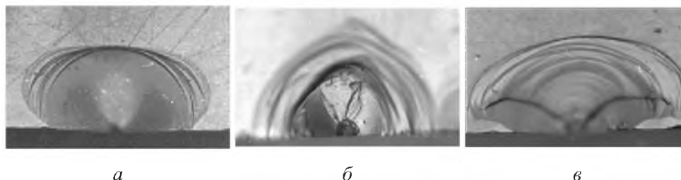
Рис. 5. Шрамы сколов под индентором Виккерса на кромках образцов оконного (а, б) и кварцевого стекла (в). (Вид со стороны ненагруженной грани.)
