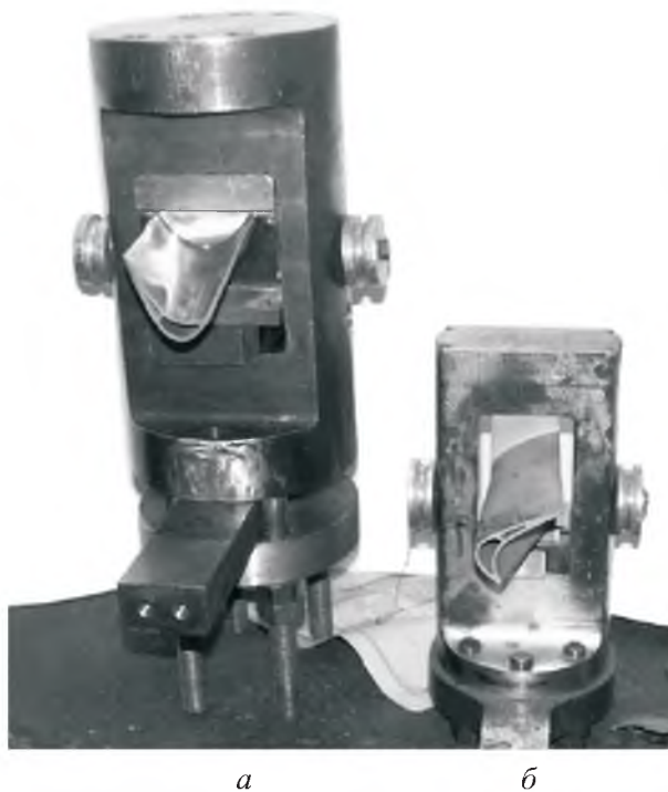
Рис. 4. Зажимы для испытания лопаток на усталость: a – первый вариант; б – второй вариант.
