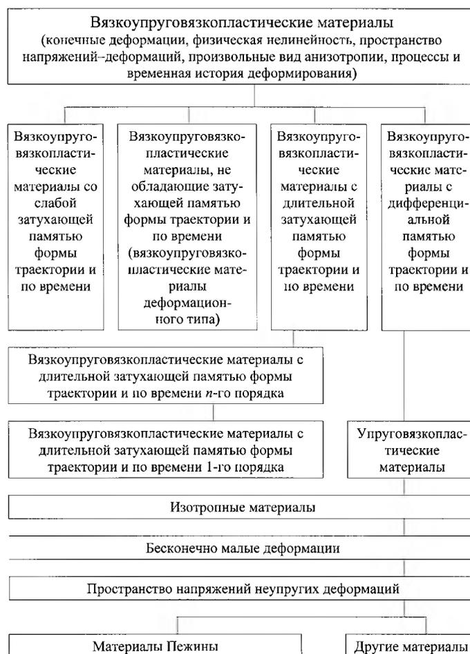
Рис. 5. Классификация моделей вязкоупруговязкопластических материалов.
