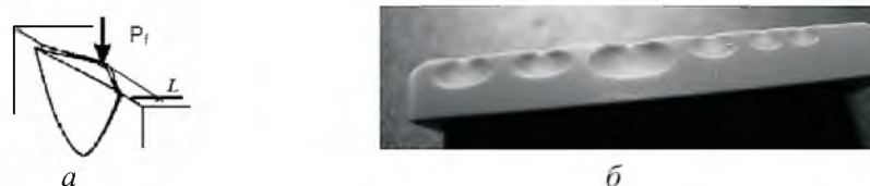
Рис. 1. Схема процесса краевого откалывания (а) и образец нитрида кремния GPSSN после испытания (б).
