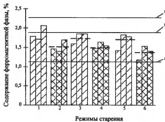
Рис. 3. Содержание ферромагнитной фазы в металле шва после эксплуатации, ТС и ТДС: а – Э; б – ТС при 450°C, 520 ч; в – ТС при 450°C, 3000 ч и ТДС при 450°C, 520 ч ( I - \sigma_k = 0 , \Delta\sigma_{\text{цикл}} = 0 ; 2 – \sigma_k = 0 , \Delta\sigma_{\text{цикл}} = -15 МПа; 3 – \sigma_k = 75 МПа, \Delta\sigma_{\text{цикл}} = 0 ; 4 – \sigma_k = 75 МПа, \Delta\sigma_{\text{цикл}} = -15 МПа; 5 – \sigma_k = 120 МПа, \Delta\sigma_{\text{цикл}} = 0 ; 6 – \sigma_k = 120 МПа, \Delta\sigma_{\text{цикл}} = -15 МПа).
