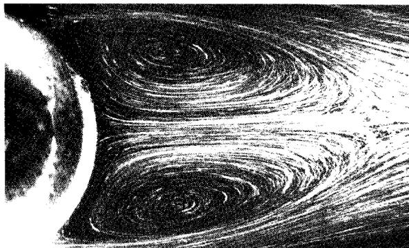
Рис. 2. Обтекание шара при  $Re=110$ , [9]
