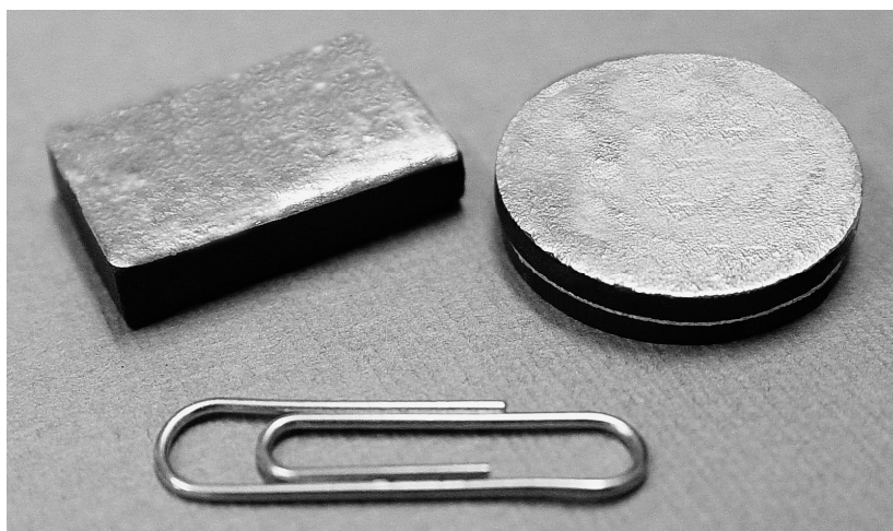
Рис. 4. Металлизация и пайка в вакууме полупроводниковой BaTiO 3 -керамики с использованием системы In—Ti
