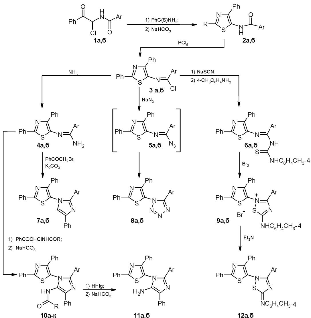
В соединениях 1-9, 11, 12: Ar = C<sub>6</sub>H<sub>5</sub>(а), 4-CH<sub>3</sub>C<sub>6</sub>H<sub>4</sub>(б);
