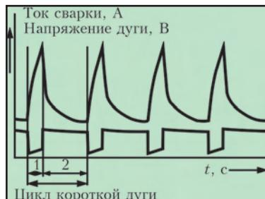
увеличивается продолжительность периода горения дуги, уменьшается частота коротких замыканий и возрастает тепловложение. С уменьшением индуктивности дросселя уменьшается период горения дуги, возрастает частота коротких замыканий и снижается тепловложение.
