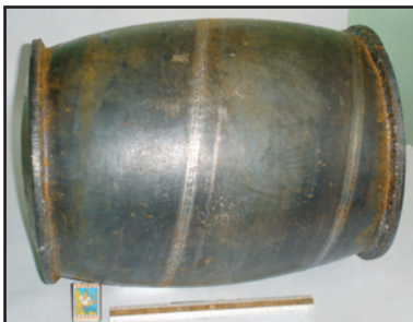
Образец спиральношовной трубы диаметром 315 мм с толщиной стенки 3 мм из стали 08кп после испытаний внутренним давлением 8,2 МПа
