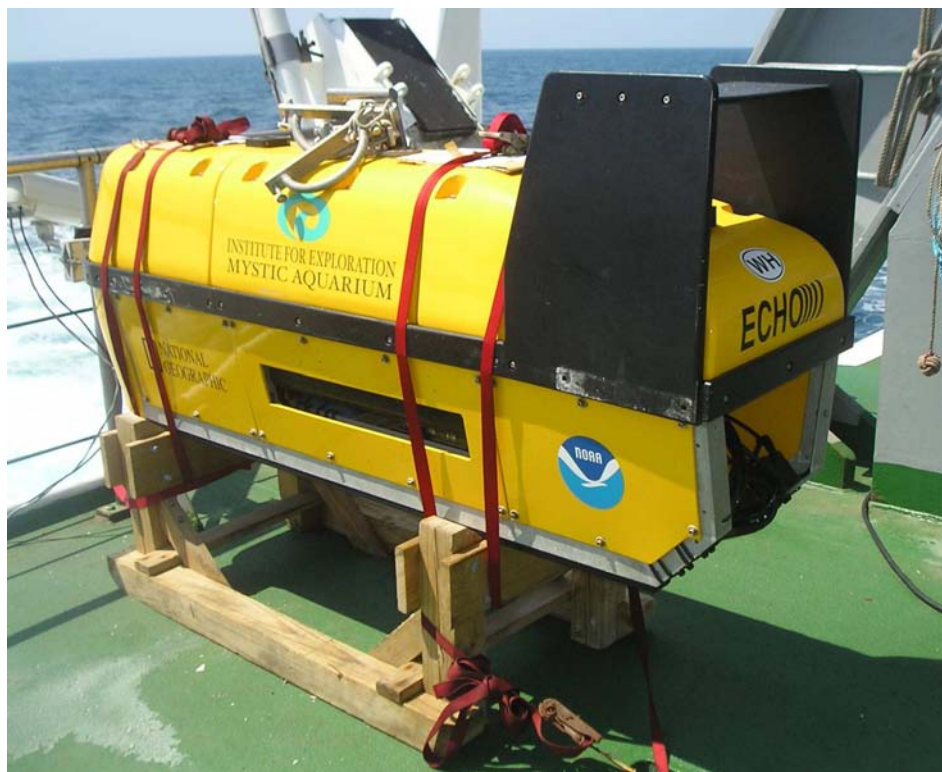
Фото 8. Ехо-сонар (гідролокатор) бокового огляду “Echo” (на штатному місці на борту г/в «Endeavor»). Українсько-американська експедиція „Чорне море-2006” (С. Воронов, Р. Баллард).
