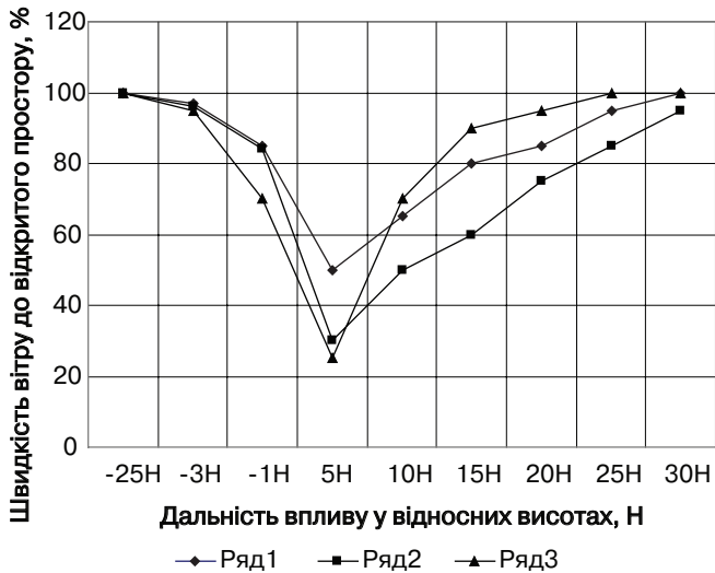
Рис. 1 – Скорочення швидкості вітру на різних відстанях з навітряного і підвітряного боку лісової смуги з різною оптичною щільністю, % (Ряд 1 – щільність 25–30%; Ряд 2 – 40–60; Ряд 3 – 100%)
