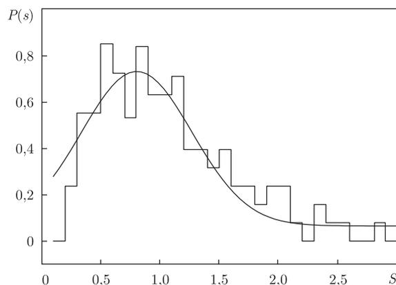
Рис. 4. Распределения межчастотных интервалов в спектре неоднородного резонатора ( $N = 30$ ). Аппроксимирующая кривая близка к распределению Вигнера
