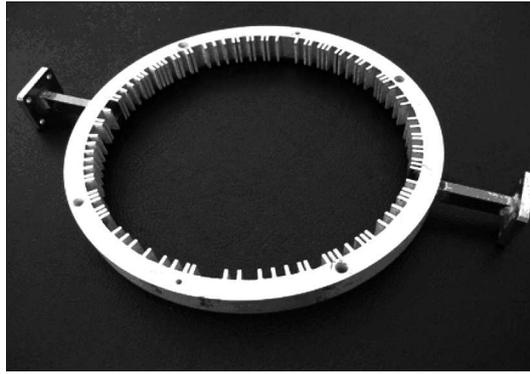
Рис. 1. Модельный цилиндрический резонатор со снятыми торцевыми крышками. Показаны случайные неоднородности на боковой стенке
