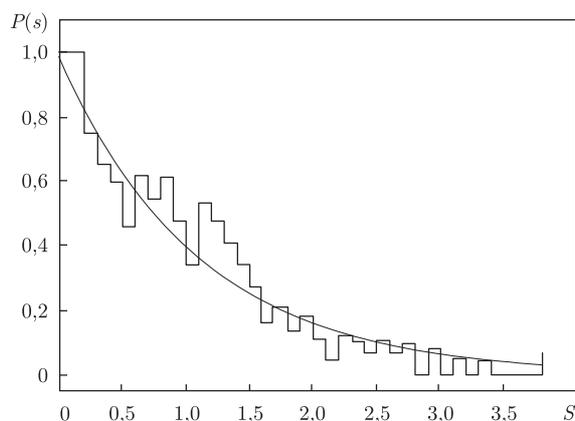
Рис. 3. Распределение межчастотных интервалов в спектре однородного цилиндрического резонатора ( $N = 0$ ). Аппроксимирующая кривая — распределение Пуассона
