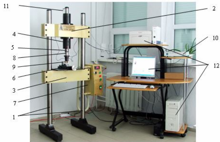
Рис. 1. Установка UTM-20HT для визначення механічних характеристик конструкційних матеріалів методом інструментованого індентування: 1 – колони; 2, 3 – нерухомі траверси; 4 – пристрій навантаження індентора; 5 – навантажувальний шток; 6 – координатний столик; 7 – блок управління установки; 8 – датчик сили; 9 – датчики переміщення; 10 – вимірювальна система Spider-8; 11 – датчик лінійних переміщень RC13-150M; 12 – система управління і обробки даних.
