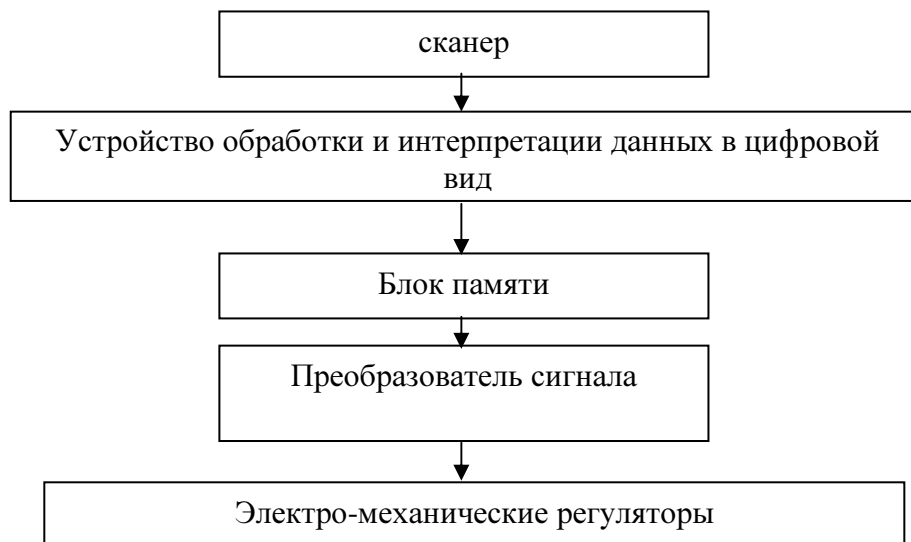
Рис. – 6 Условная схема процесса предварительного экспресс-сканирования обнаженного породного контура
