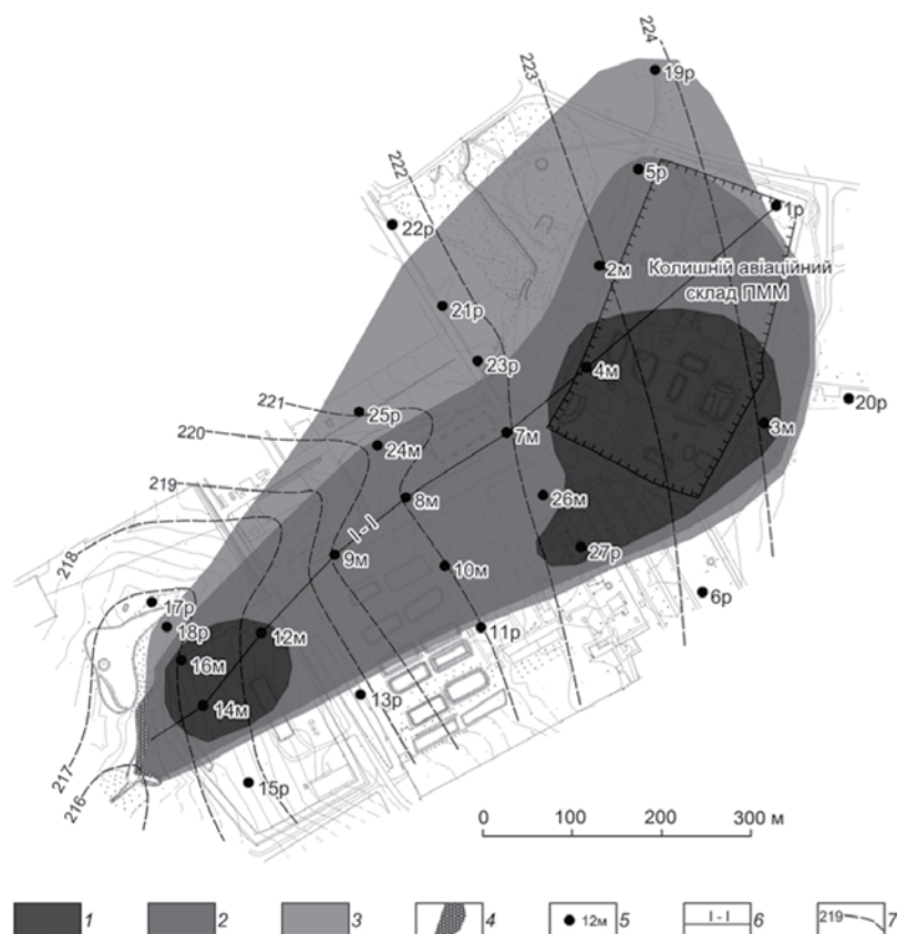
Рис. 1. Схема розповсюдження забруднення нафтопродуктами в геологічному середовищі: Потужність шару мобільних нафтопродуктів: 1 — >1 м; 2 — 1 — 0 м; 3 — зона забруднених ґрунтів; 4 — місце просочування нафтопродуктів у верхів ї ур. Сухий Яр; 5 — моніторинго-ві та розвідувальні свердловини; 6 — лінія геолого-гідрогеологічного розрізу; 7 — п'єзоізогіпси ґрунтового водоносного горизонту станом на липень 2008 р.
