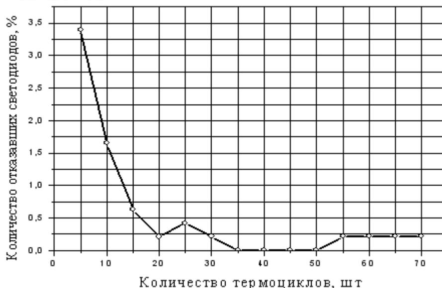
Рис.1. Зависимость количества отказавших зеленых светодиодов после проведения процессов их термоциклирования от количества
