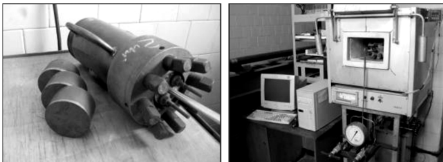
Рис. 4. Камера и установка для наводороживания образцов.
