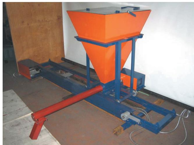
Рис. 2. Общий вид опытно-промышленного дозирующего устройства
