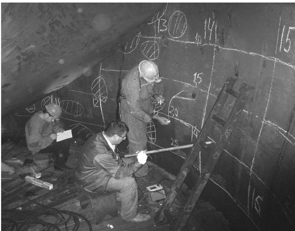
Рис.4 – Выделение зон отслоения защитной оболочки от железобетона по результатам виброакустической диагностики
