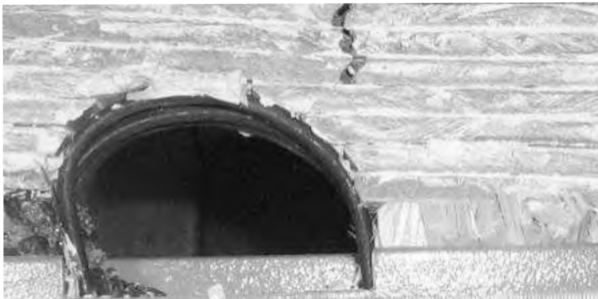
Рис. 6 – Характер деформации контура выработки по данным физического моделирования
