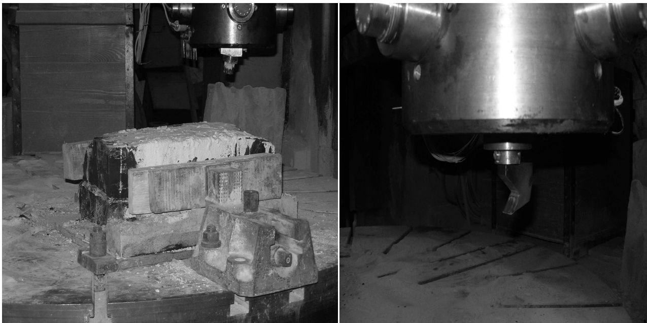
Рис.1. Внешний вид оборудования с блоком угля и режущий инструмент для измерения сопротивляемости резанию
