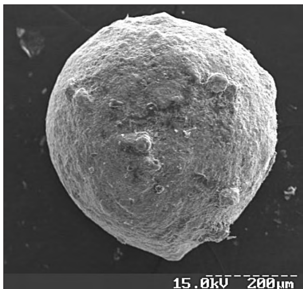
Fig. 6. Globule of native bismuth containing bismuth tellurides — Se-tsumoite, joseite-A, joseite-B (Smerekiv Kamin')
