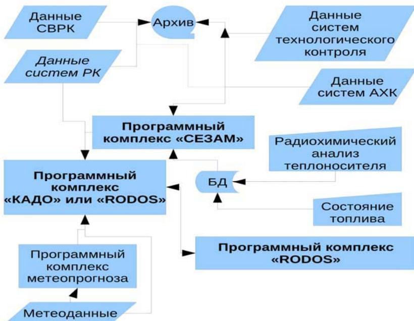
Рис. 1. Общий вид комплекса средств поддержки оператора при радиационных авариях: СВРК — система внутриреакторного контроля; РК — радиационный контроль; АХК — автоматический химический контроль; БД — база данных.
