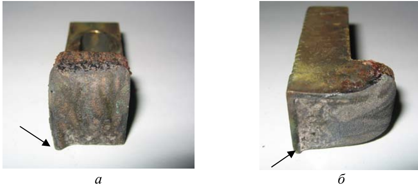
Рис. 1. Виступи на контактних поверхнях, викликані зміщенням контактів: a — матеріал № 3; б — матеріал № 4.
