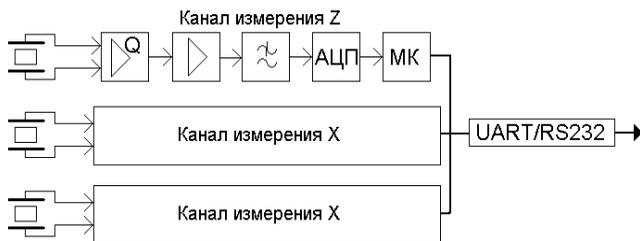
Рис.1. Структурная схема Измерительного преобразователя.
