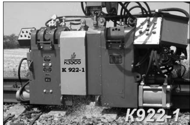
Рис. 3. Подвесная рельсо-сварочная машина К922
