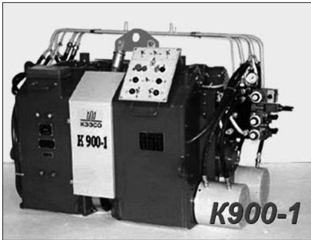
Рис. 1. Подвесная рельсосварочная машина K900
