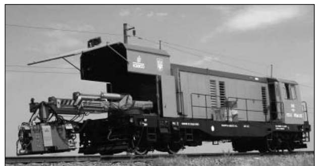
Рис. 5. Путьевая рельсо-сварочная самоходная машина ПРСМ-3
