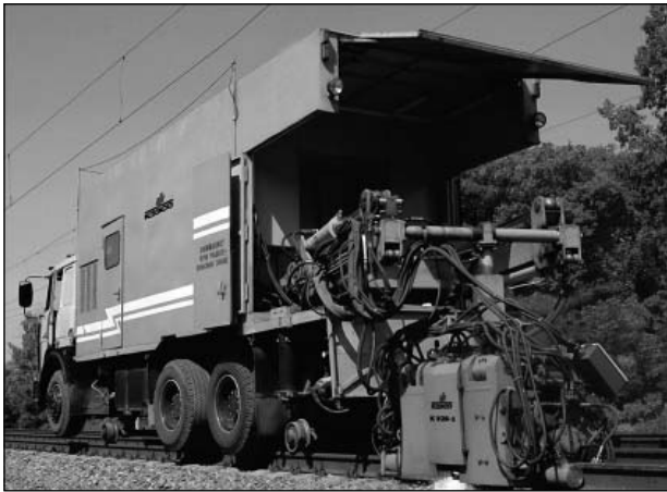
Рис. 7. Мобильный рельсосварочный комплекс КСМ005
