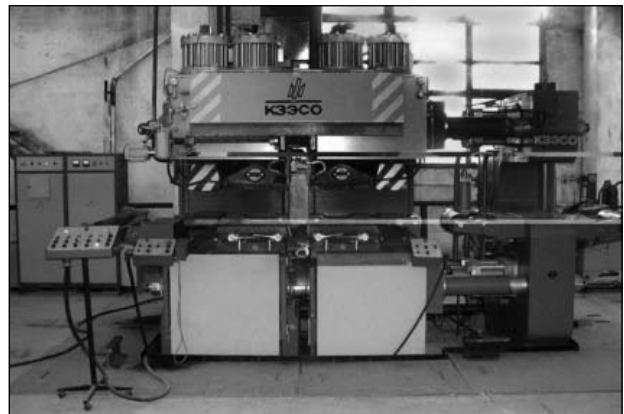
Рис. 9. Стационарная сварочная машина для сварки стрелочных переводов К924
