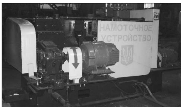
Рис. 9. Намоточное устройство в линии созданного участка
