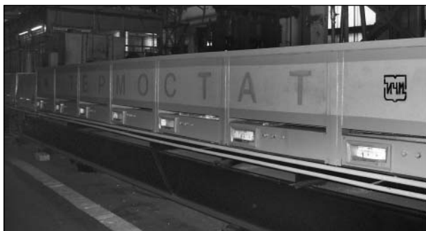
Рис. 6. Линия термостатирования опытно-промышленного участка
