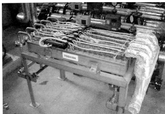
Рис. 8. Демонстрационная система генерирования (150 Вт) мощности, использующая горячие источники.
