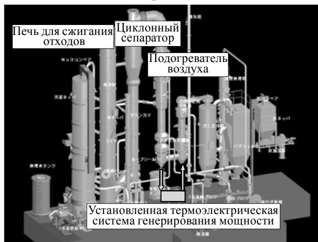
Рис. 4. Демонстрационная испытательная установка в системе для сжигания отходов очистных сооружений.
