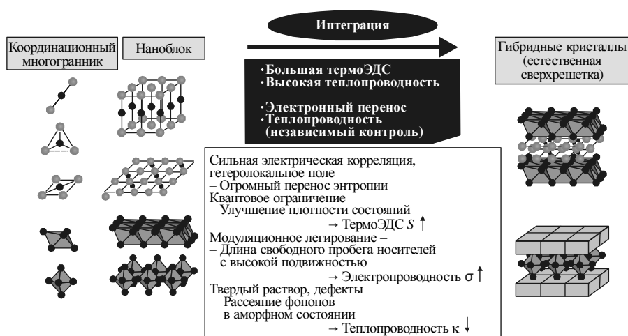
Рис. 12. Принцип наноблочного объединения слоистых оксидов.
