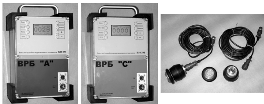
Рис.2. Выносное оборудование корреляционного течискателя: ВРБ "А", ВРБ "С", два вибродатчика ВДМ-2.
