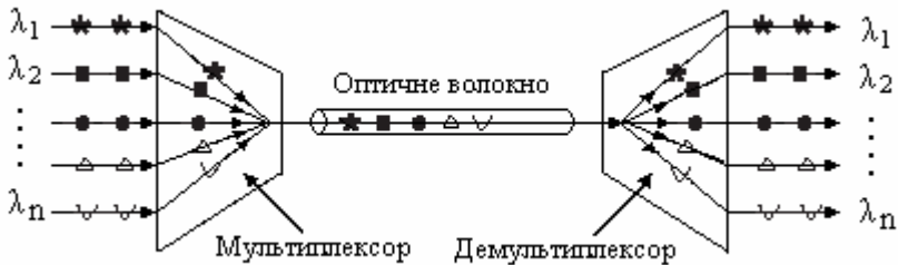
Рис.4. Схема частотного (спектрального) мультиплексування
