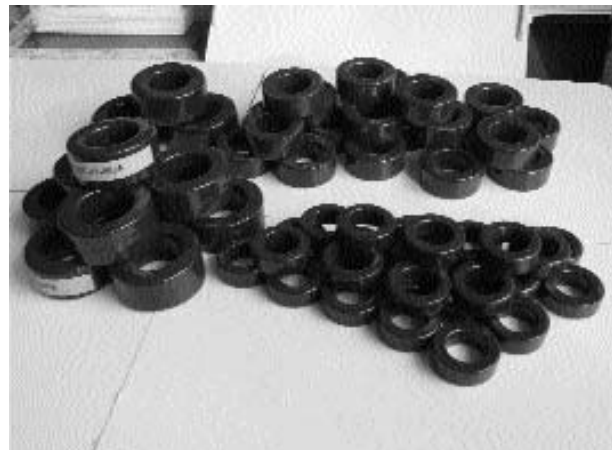
Рис. 5. Дослідно-промислові партії тороїдальних магнітопроводів із всебічним полімерним покриттям
