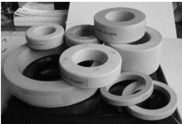
Рис. 4. Зразки монолітних тороїдальних стрічкових нанокристалічних осердь різного розміру, в т. ч. прямокутне стрічкове осердя 14×14/750
