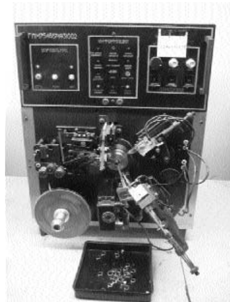
Рис. 3. Автоматизований станок для намотування магнітопроводів "Модуль-30"
