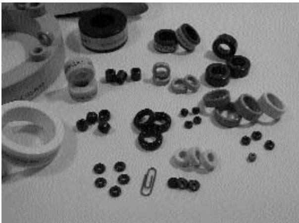
Рис. 5. Дослідно-промислові партії тороїдальних магнітопроводів із всебічним полімерним покриттям
