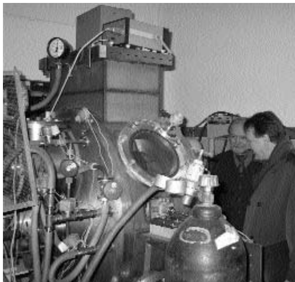
Рис. 2. Виконавчий директор УНТЦ Ів Кармель оглядає автоматизовану установку НШОР для гартування розплаву в захисній атмосфері (2004 р.)
