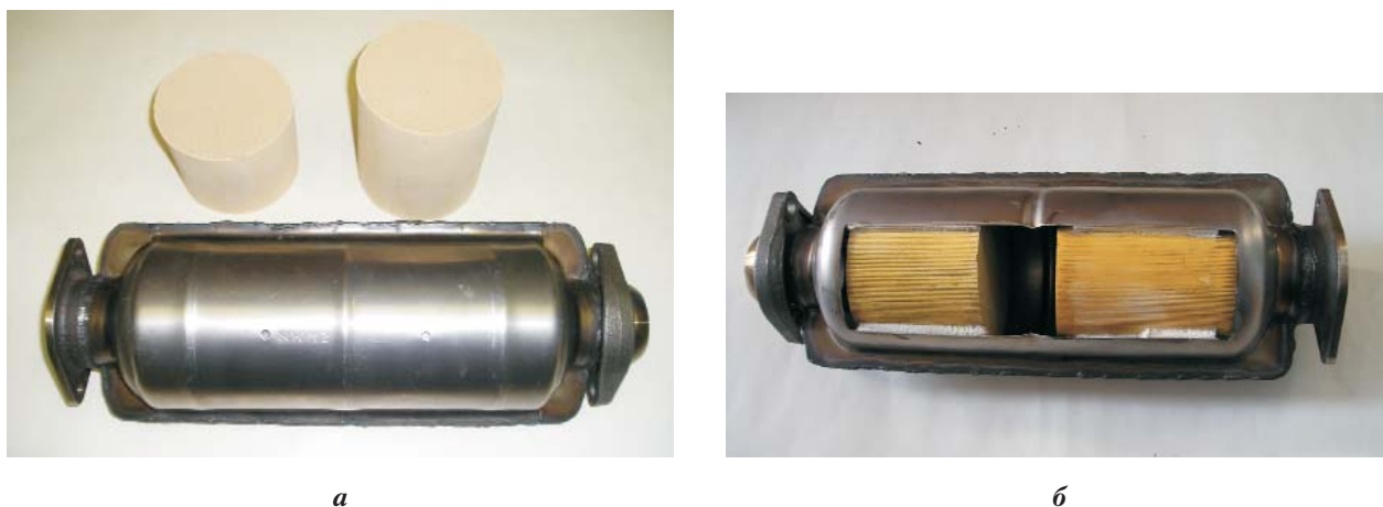
Рис. 4. Каталітичний нейтралізатор для автомобілів ВАЗ: а – загальний вид нейтралізатора і каталізаторних блоків; б – каталітичний нейтралізатор в розрізі
