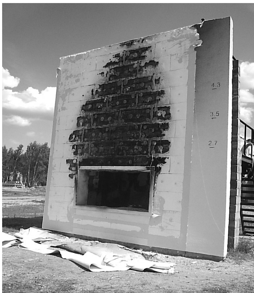
Рис. 2. Вид на строение (Испытание № 2) после удаления внешнего слоя штукатурки.
