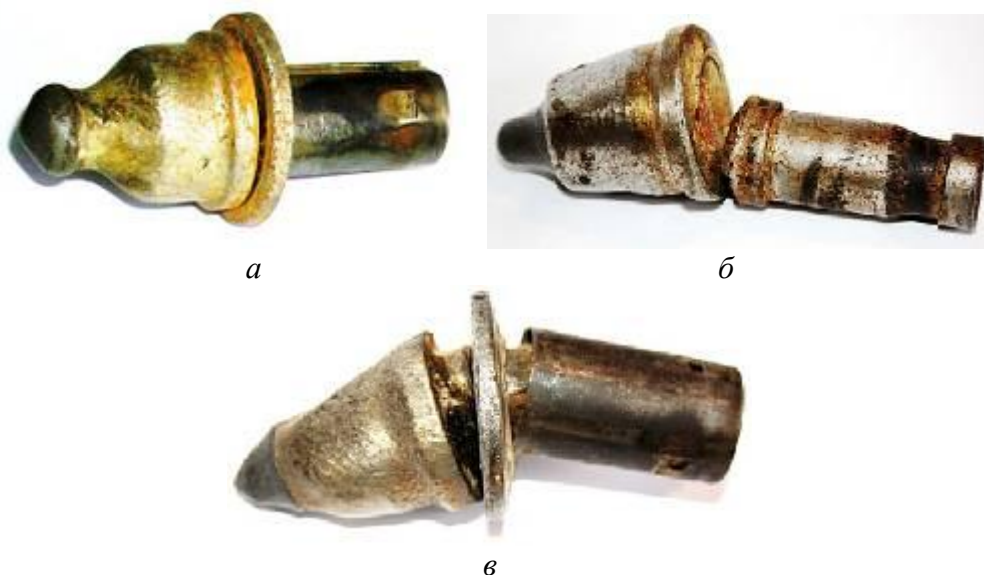
Рис. 1. Загальний вигляд відпрацьованих різців залежно від умов їх гартування під час виготовлення: а – нормальне зношення; б – поломка державки різця в зоні його кріплення; в – згин державки
