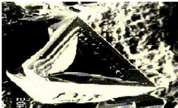
Рис. 1. Микрофотография скелетных кристаллов алмаза фракции 250/200 мкм, полученных при концентрации ц.к.  $N_3/V = 40$  ц.к./мм<sup>3</sup> при  $p = 4,5$  ГПа,  $T = 1520$  К и  $\tau = 90$  с
