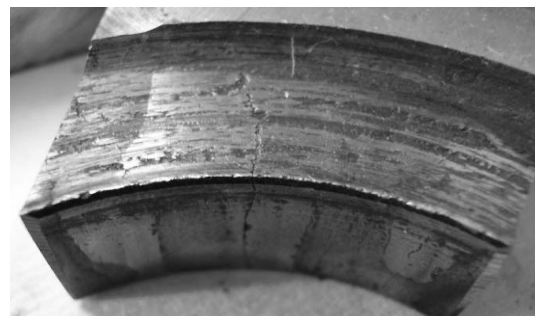
Рис. 2. Загальний вигляд руйнування цементованого упорного торця шарошки (темплет шарошки)
