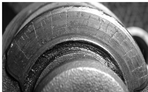
Рис. 1. Загальний вигляд зношення наплавленого упорного торця бурта лапи
