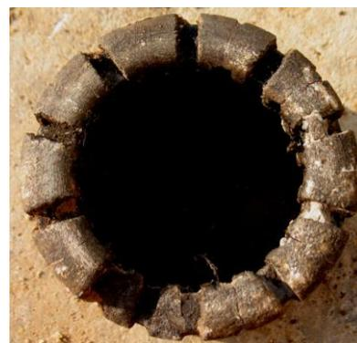
Рис. 4. Общий вид состояния изнашивания и разрушения матрицы коронки нового типа перед обнажением каналов второго слоя
