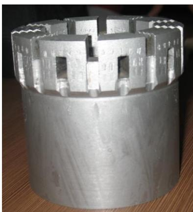
*Рис. 1. Общий вид алмазной импрегнированной коронки с высокой матрицей и двухслойными промывочными каналами для бурения снарядом ССК*
