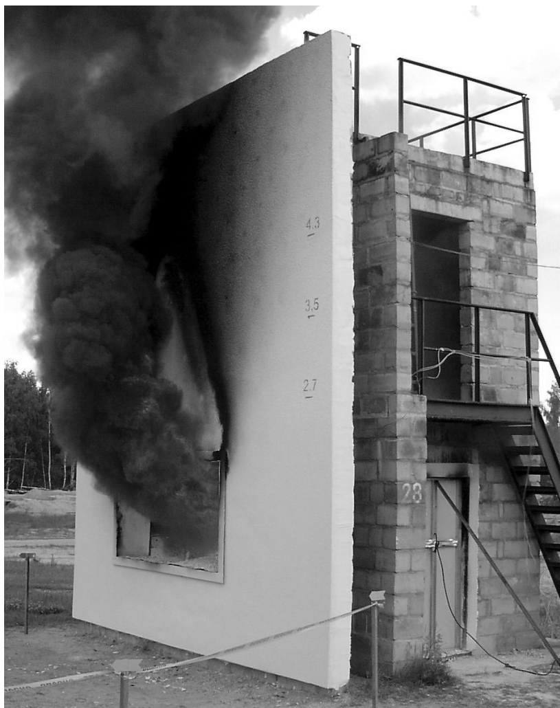
Рис. 3. Натурні випробування фрагменту теплоізолюючої оздоблювальної конструкції.
