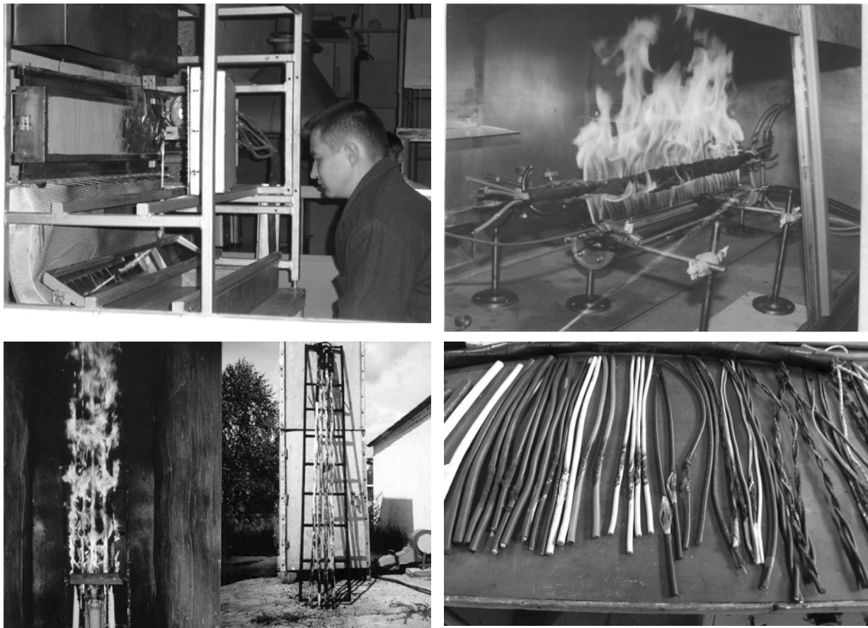
Рис. 2. Випробування кабельної продукції та електротехнічних виробів
