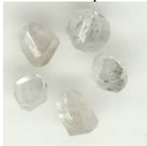
Рис. 3. Общий вид монокристаллов алмаза типа IIa, выращенных в системе Mg – 50 ат. % C, P = 8 ГПа, T = 1820–1850 °C, масса 0,08; 0,06; 0,05; 0,04; 0,04 карат
