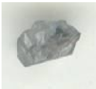
Рис. 2. Общий вид монокристалла алмаза типа IIa, выращенного в системе Mg – 50 ат. % C; P = 8 ГПа, T = 1850 °C
