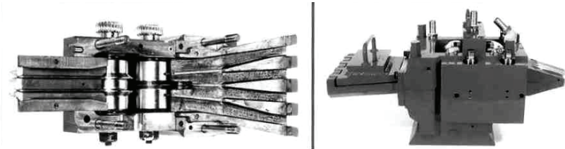
Рис.6. Общий вид и вид со снятой верхней крышкой неприводного делительного устройства для деления раската на 4 нитки
