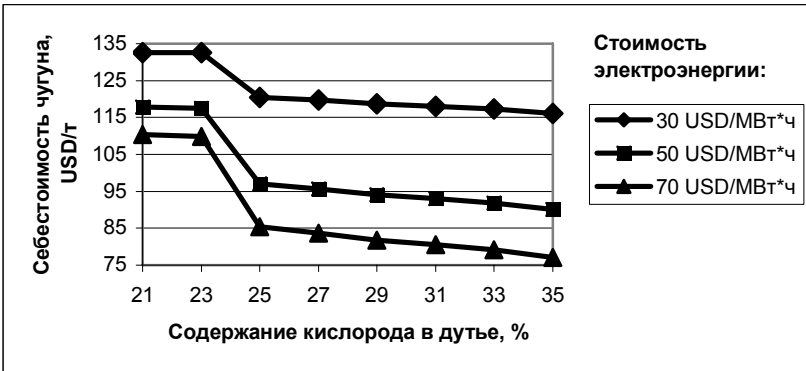
Рис.3. Зависимость себестоимости чугуна от содержания кислорода в дутье при разных ценах на электроэнергию
