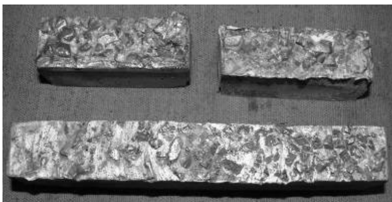
Рис. 2. Внешний вид лопастей с припоем ЛНМц 60-9-5 после отработки под нагрузкой 4 т
