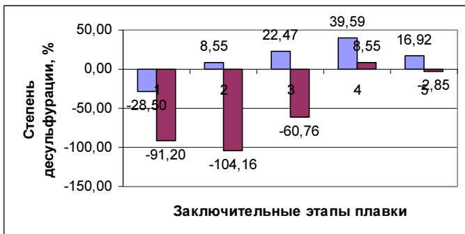
Рис.3. Изменение степени десульфурации по заключительным этапам плавки.
