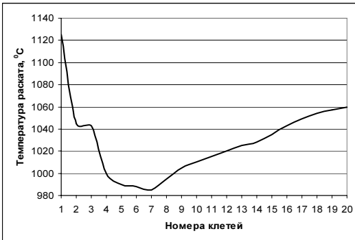
Рис.1. Изменение температуры раската по длине стана 320/150 при прокатке круглого профиля диаметром 10мм в прутках (данные 1986г.)
