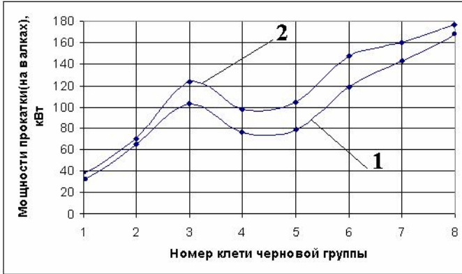
Рис.3. Изменение мощности потребляемой двигателями, по клетям черновой группы стана 250/150–6. 1–рассчитанная 2– фактическая
