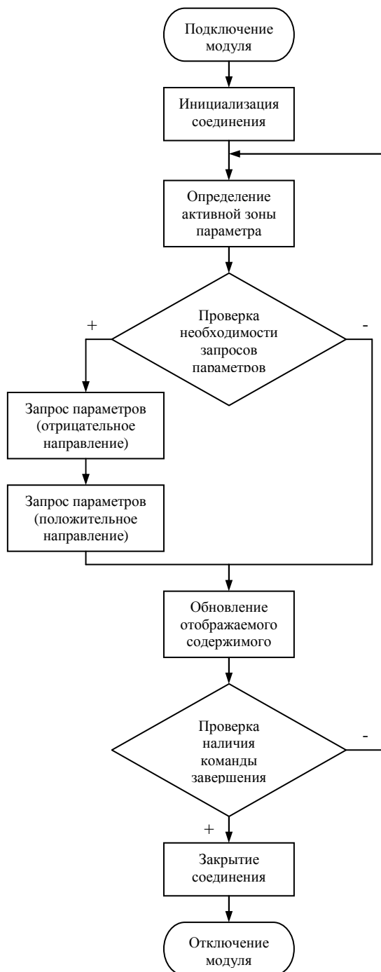
Рис. 6. Алгоритм взаимодействия основной программы с подключаемыми модулями
