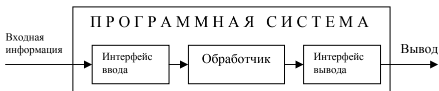
Рис. 1. Структура программной системы с минимальным количеством описателей входной информации (оптимальная архитектура)
