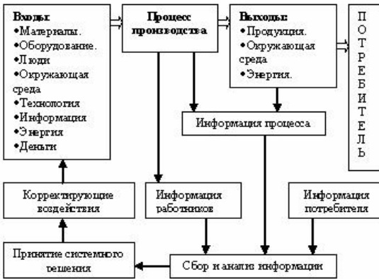
Рис.8. Принципиальная схема получения и использования параметров для обеспечения промышленной безопасности производства в изменяющихся условиях
