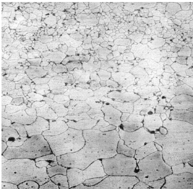
Рис. 4. Микроструктура особотонкой листовой стали 08пс после осадки с низкотемпературного нагрева ( 700^{\circ}\text{C} ) за одно нагружение при температуре металла 700^{\circ}\text{C} и охлаждении вместе с печью от 650^{\circ}\text{C} , \times 200 .
