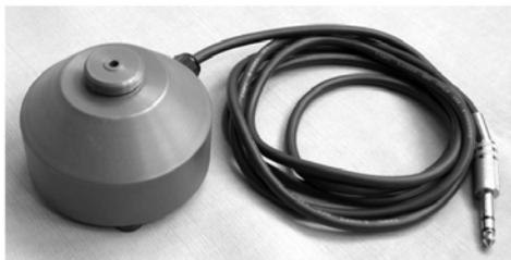
**Рис.1. Камера малого объема с излучателем**
